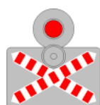
G1bis Signalisation de position des passages à niveau à une voie munis d'une signalisation automatique lumineuse et sonore sans barrière ni demi-barrière. Les signaux G1bis et G1b bis sont composés respectivement d'un panneau G1 ou G1b complété par un signal sonore et un feu clignotant dont le fonctionnement annonce l'arrivée des trains
