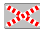
G1 Signalisation de position, d'une part, des passages à niveau à une voie sans barrières ni demi-barrières et non munis de signalisation automatique et, d'autre part, des aires de danger aérien où les mouvements d'avions à basse altitude constituent un danger pour la circulation routière. Dans ce dernier cas le panneau est complété par un dispositif lumineux d'interruption de la circulation (deux feux rouges clignotants alternativement et placés à la même hauteur)
